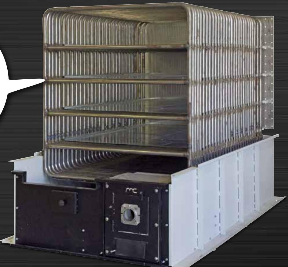
Il diametro 27 – sp. 4 mm. permette di avere una massa notevole di tubi (peso kg.4 al metro lineare), pertanto non serve portare a temperatura elevata il vapore nel tubo in quanto la massa elevata fa in modo che la cottura sia assolutamente dolce ed è sempre pronto ad una nuova cottura.
